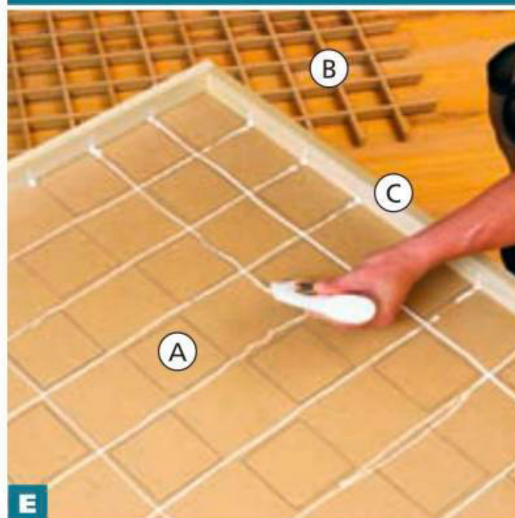
Е Ориентируясь на линии, быстро нанесите полоски клея на нижнюю панель А и планки С.
