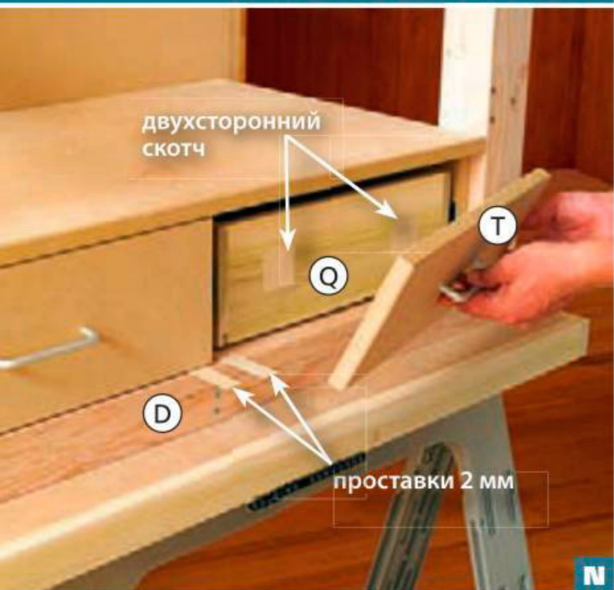
Проставки помогают создать одинаковые зазоры между фальшпанелями T и длинной перекладиной D. Тщательно выровняйте зазоры сверху и с боков.
