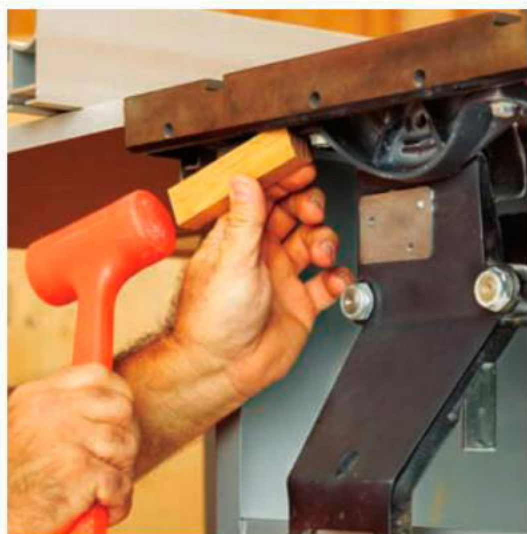
В станке плотницкого типа ослабьте болты крепления пильного узла. С помощью киянки и обрезка выровняйте диск параллельно пазу стола.
