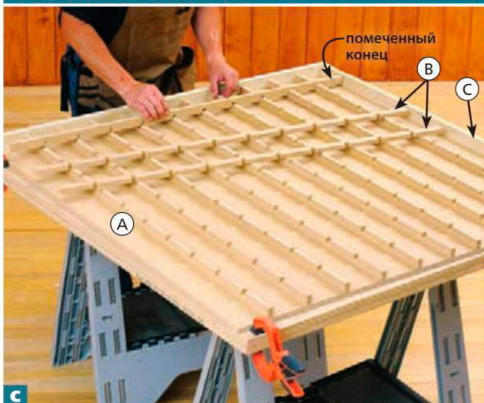
C Выравнивайте нижние рейки В, прижимая их торцы к приклеенным планкам С. Соедините вырезы без клея.
