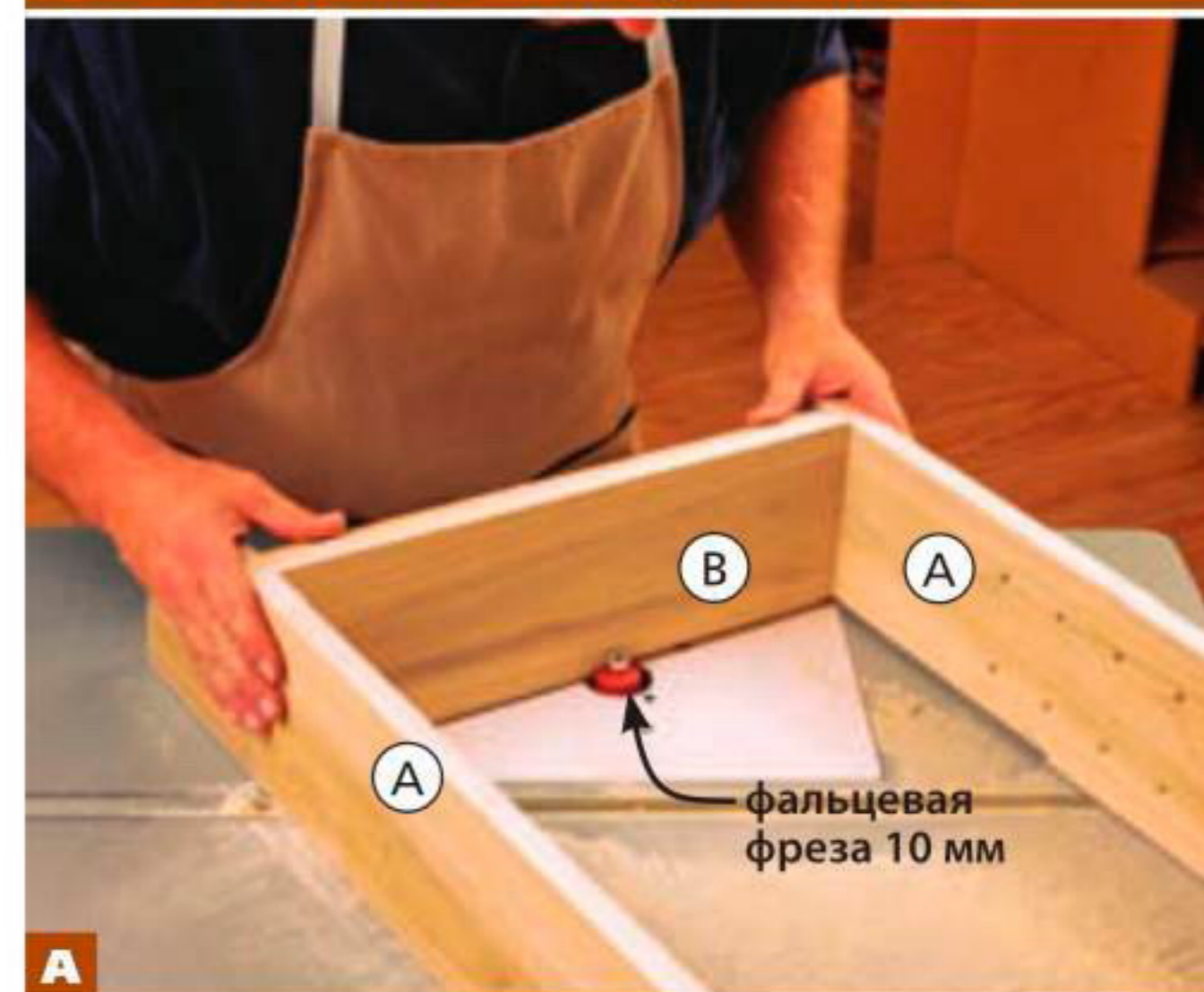
Установите в фрезерный стол фрезу для фальцев шириной 10 мм. Оперев корпус на фрезерный стол, отфрезеруйте фальц глубиной 6 мм в боковых стенках А, дне В и перекладине С.
