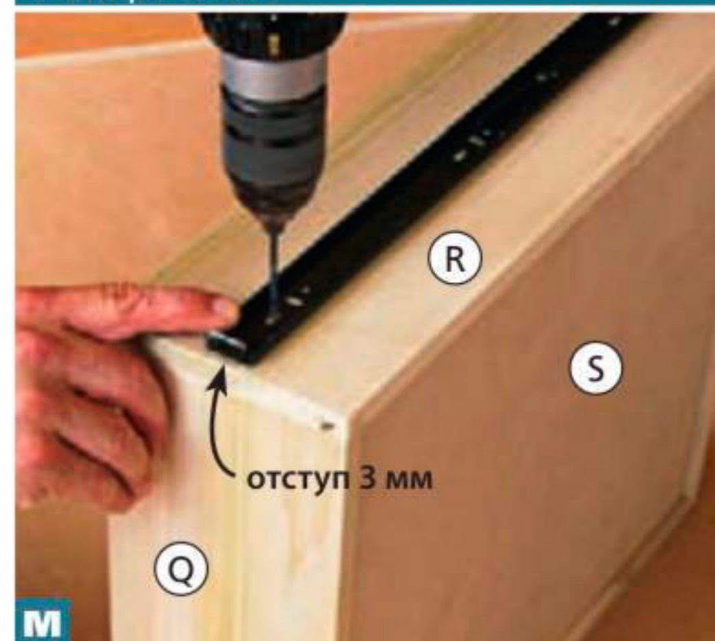
Сделайте отверстия для шурупов в середине монтажных прорезей, чтобы направляющую можно было сдвинуть вперед или назад после установки в ящичный отсек О/Р.
