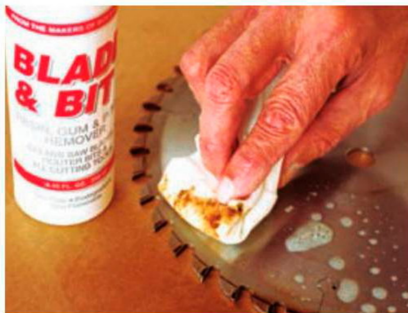
Если зубья диска острые, достаточно смыть загрязнения специальным чистящим средством.
