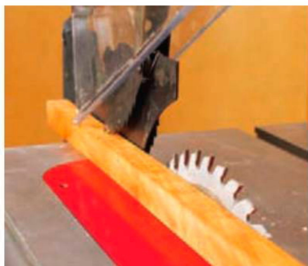
С помощью прямого бруска убедитесь, что расклинивающий нож расположен точно позади пильного диска и не мешает продвижению заготовки.
