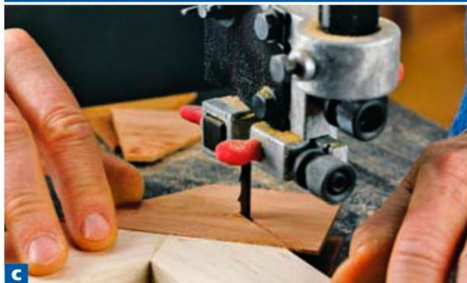
С Удалите излишки материала накладок ленточной пилой, а затем отшлифуйте лицевую сторону и кромки, используя эксцентриковую шлифмашину.
