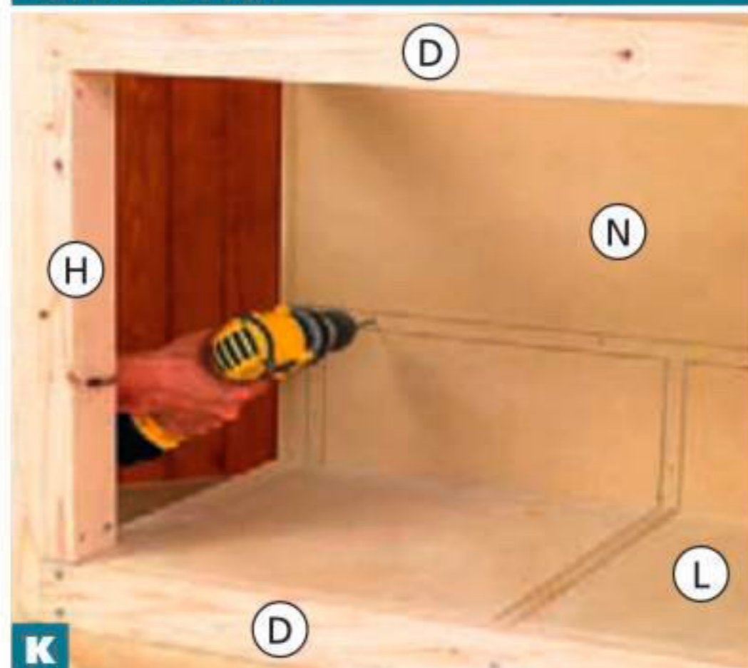
Обведя края деталей ящичного отсека О/Р, просверлите между линиями отверстия для крепления его к нижней панели L и задней стенке N.
