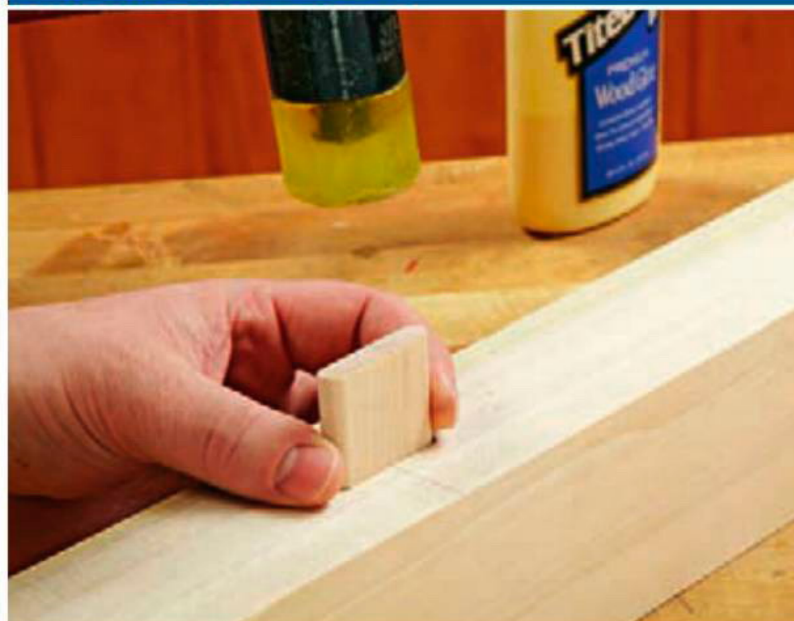
Смазав стенки гнезда и нижнюю часть шипа клеем, вставьте шип в гнездо до упора, слегка ударяя, если требуется, киянкой.
