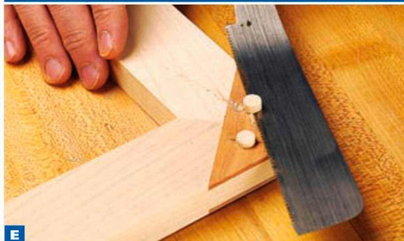
E Взяв для этой операции мелкозубую ножовку с гибким полотном, направляйте ее параллельно волокнам накладки, чтобы не оставить грубых царапин.
