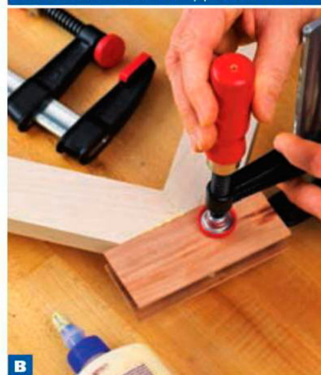
В Эти накладки остроганы до толщины, которая на 0,5 мм больше глубины фальцев на углах рамки.
