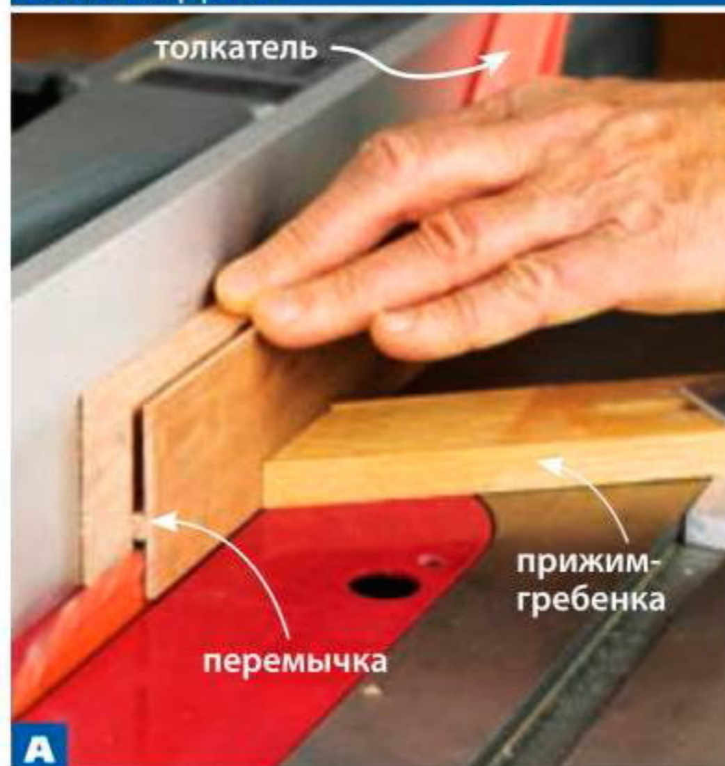
А Между пропилами оставьте перемычку шириной около 12 мм. Затем распилите перемычку с помощью ленточной пилы или ручную.
