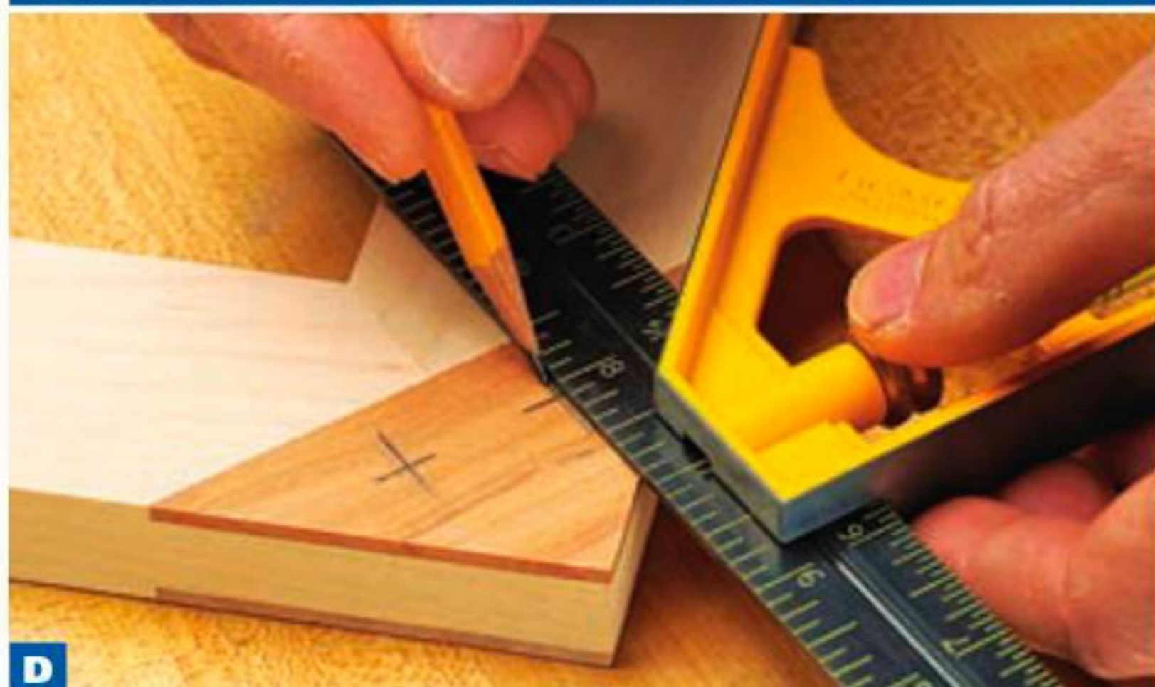
D Располагайте пробки на равных расстояниях от линии стыка деталей рамки. Размеры и расположение пробок должны соответствовать рамке и накладкам.
