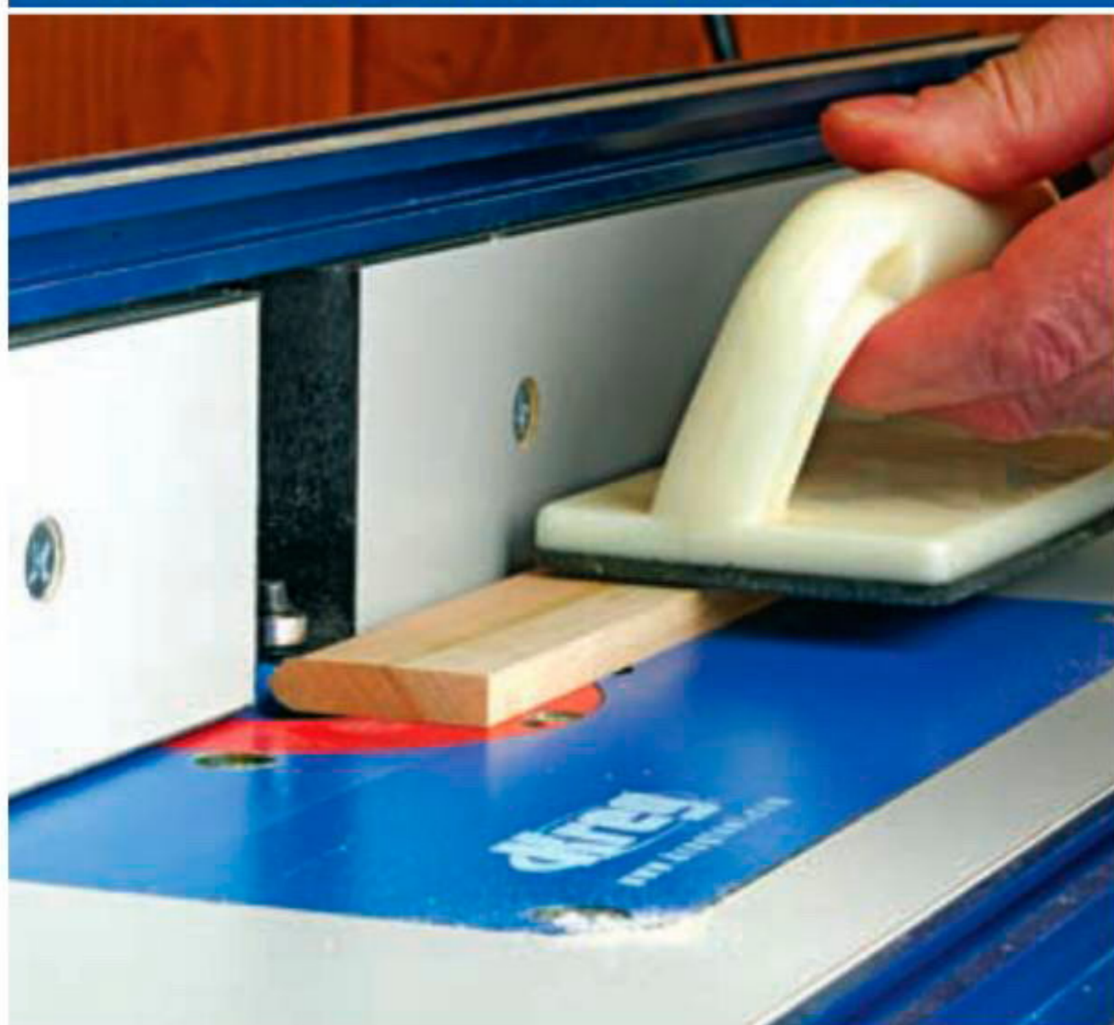
Используя фрезу для скруглений радиусом чуть больше половины толщины шипа (6 мм для 10-миллиметровой заготовки), отфрезеруйте кромки, которые должны стать слегка заостренными.
